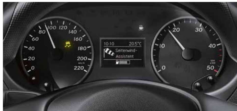
Le système de stabilisation en cas de vent latéral de série contribue à éviter les déports en cas de rafales de vent transversales.
