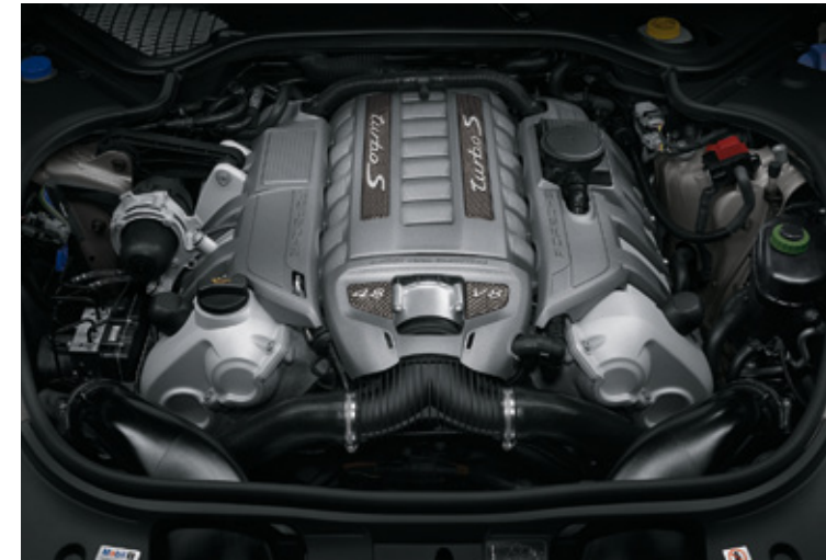
Moteur V8 biturbo de la Panamera Turbo S
