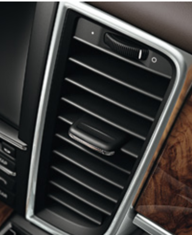
Buses de ventilation de la console centrale
