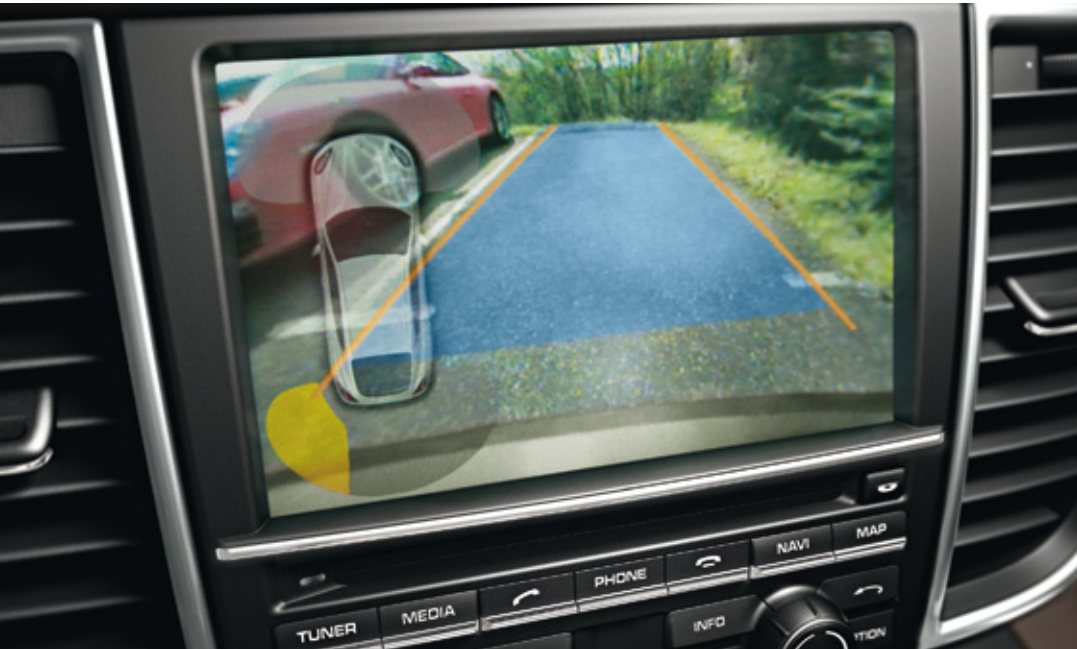
Image de la caméra de recul affichée sur le PCM
