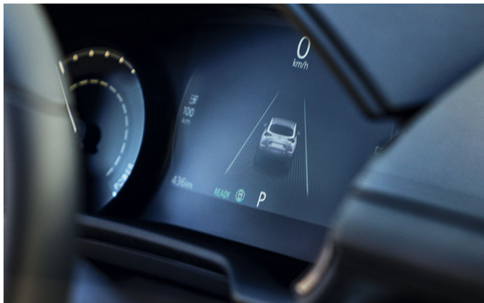
Compteur numérique 7" avec ordinateur de bord couleur
