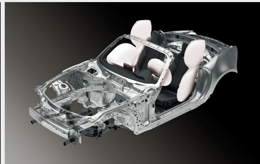
STRUCTURE DE CAISSE : rigidité et légèreté.
