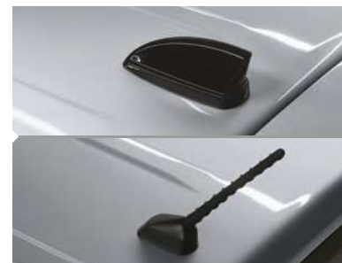
Antenne „aileron de requin” (en haut) antenne-mât (en bas)
