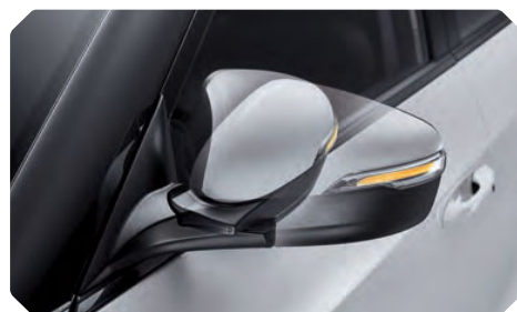
Rétroviseurs extérieurs à réglage électrique, chauffants et rabattables
