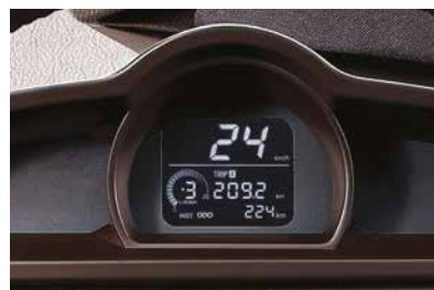
Ordinateur de bord* avec GSI (Indicateur de Changement de Vitesse) et TPMS (Contrôle de la Pression des Pneumatiques)
