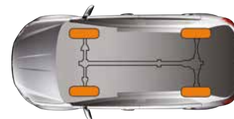
Fonction « Lock » enclenchée : Répartition 50/50 du couple sur l'avant et l'arrière avec blocage du différentiel central (jusqu'à 40 km/h maximum)
