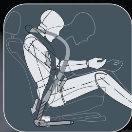
Prétensionneurs et limiteurs d'effort équipent les ceintures de sécurité à l'avant.
