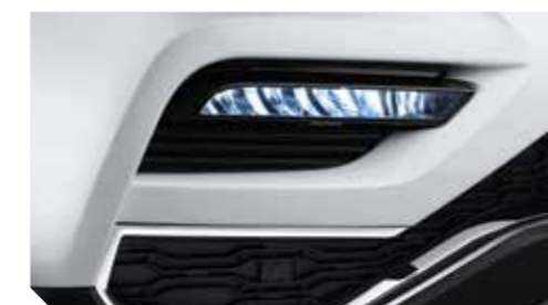
Éclairage statique d'intersection à LED avec phare antibrouillard
