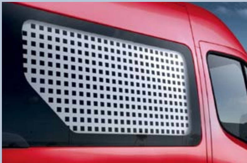
Grilles de protection des vitres latérales. Grilles en métal perforées revêtues de résine époxy, montées à l'intérieur, pour protéger les vitres contre les détériorations qui pourraient être causées par le chargement.
