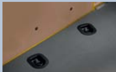
Anneaux d'arrimage fixes. Idéalement situés, 4, 6, 8 ou 10 anneaux d'arrimage au plancher (en fonction de la longueur du véhicule) permettent de sécuriser les chargements et de les maintenir en place en toute sécurité.
