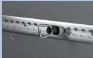
Anneaux d'ancrage mobiles. Conçus pour le système de rails de l'Opel Movano, ces anneaux sont en acier avec bouton-poussoir verrouillant le mécanisme.
