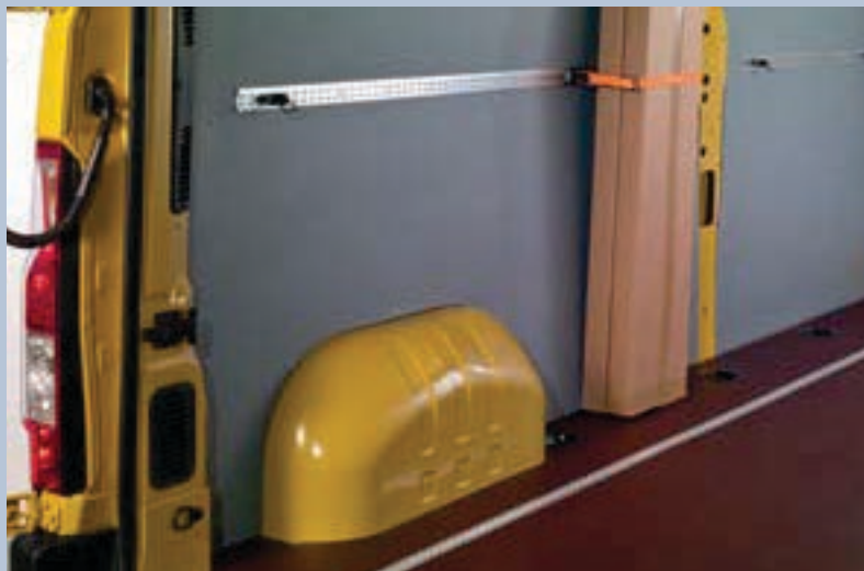
Sangles d'arrimage (x 2). Sangles pour sécurisation des charges sur les rails latéraux, garantissant un espace de chargement sécurisé.
