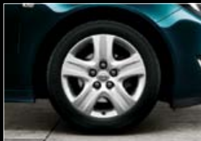
Jante design avec enjoliveur, 7 J x 17", 5 branches avec enjoliveur de moyeu de roue spécial, pneus 225/55 R 17 (RVE). 2
