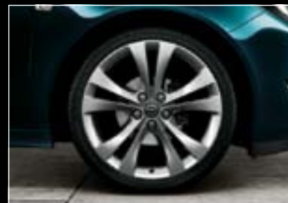
Jante alliage, 8,5 J x 20", 5 branches doubles, avec finition laquée multi-couches haut de gamme, pneus 245/35 R 20 (RTH). 4
