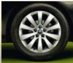
Jantes alliage, 7 J x 17" multibranches, pneus 215 (225)/50 R 17 (PGQ). De série sur Cosmo.
