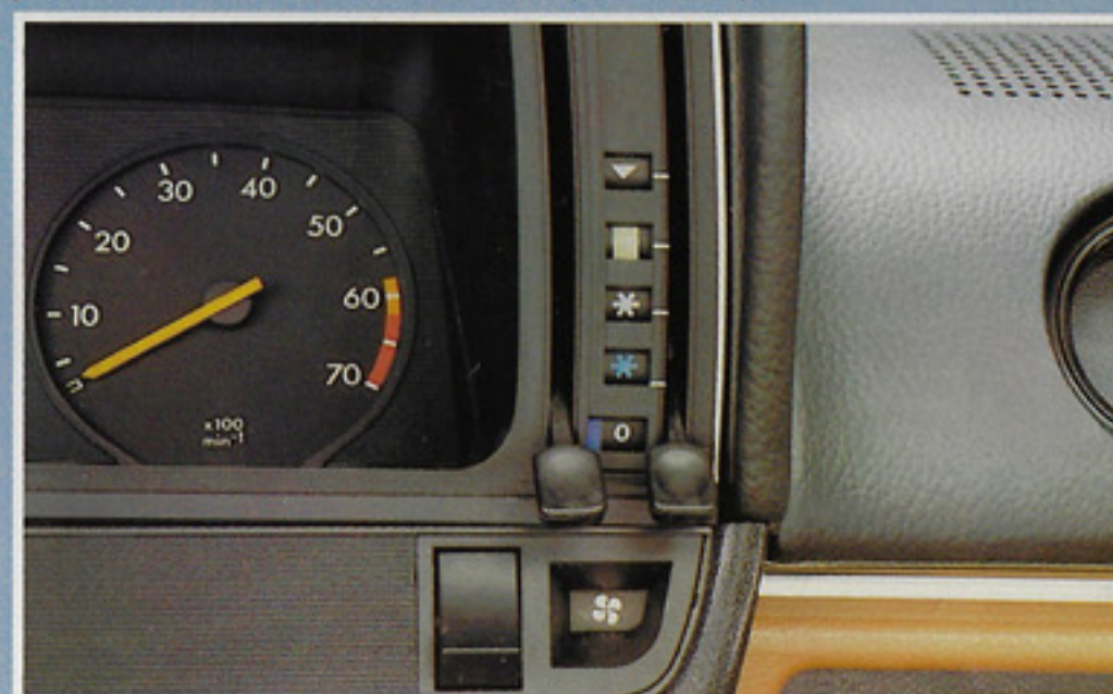
Prima Klima: Die Klimaanlage hält, unabhängig von den Witterungsbedingungen, die eingestellte Temperatur.
