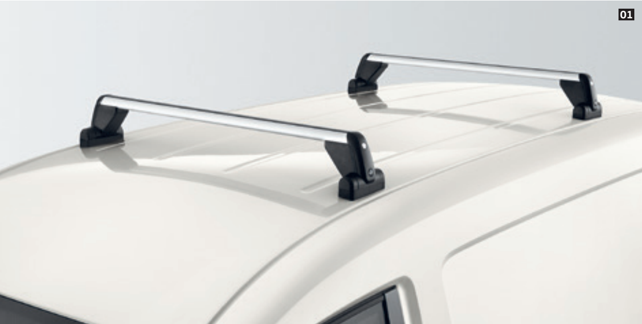
01 Porte-charges de base. Un porte-charges de base verrouillable, en profilé d'aluminium anodisé testé City-Crash est disponible pour les véhicules sans rails de toit. Conçu pour une charge allant jusqu'à 94 kg, il peut recevoir différents systèmes de transport. | VA | BL |
