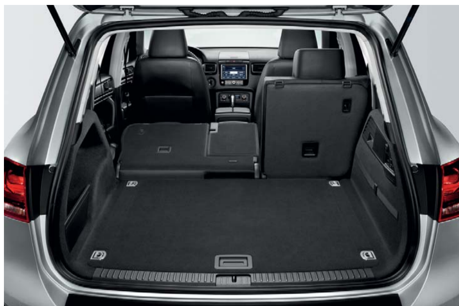
Banquette arrière 40/60 modulable (coulissante, rabattable électriquement et inclinable).
