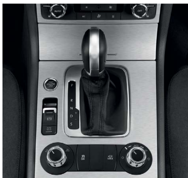
Boîte de vitesse 'Tiptronic' à 8 rapports et frein à main électromagnétique avec fonction Auto Hold.
