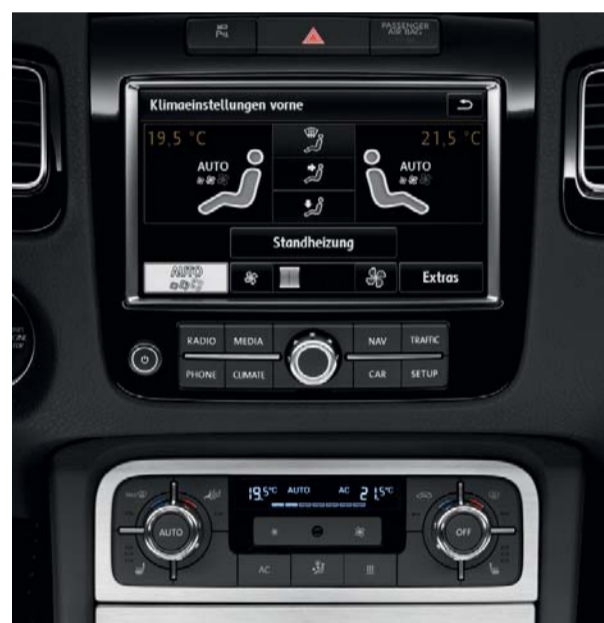
Climatisation 'Climatronic 2C', réglable séparément gauche et droite pour les passagers avant, recyclage automatique avec capteur de pollution et touche "Rest". GPS en option sur Carat Edition
