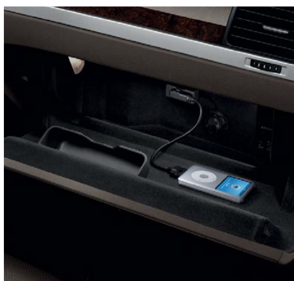
'MEDIA-IN' Ipod Interface multimedia USB dans la boîte à gants pour iPod de 4 ème génération, lecteur MP3 ou clé USB.
