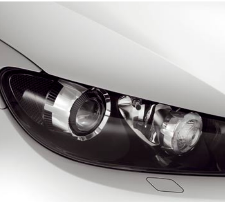
Les optiques bi-xénon (2) directionnels avec éclairage statique d'intersection permettent une visibilité optimale en toutes circonstances (en option).
