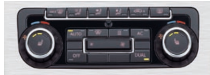
Individualisable : la climatisation "Climatronic" de série sur Sportline et Carat, dispose d'une régulation de température séparée pour le conducteur et le passager avant. Les sièges chauffants sont de série sur Carat.
