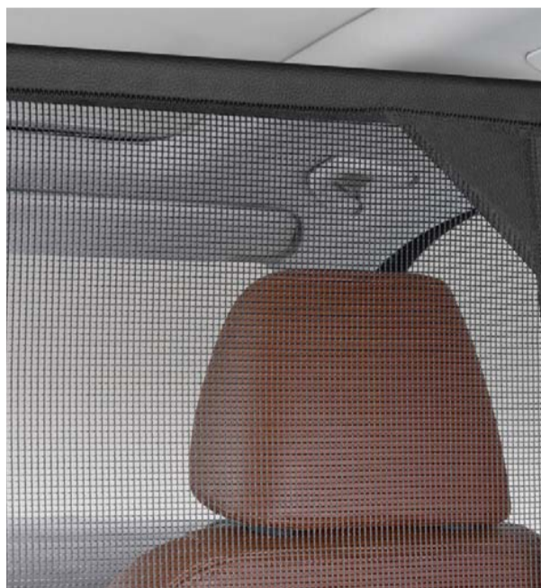
Filet de séparation. Sécurise le chargement et le transport des animaux dans le coffre. Il protège ainsi les passagers en cas de freinage brutal. Il se fixe uniquement derrière les sièges passager avant (en option).
