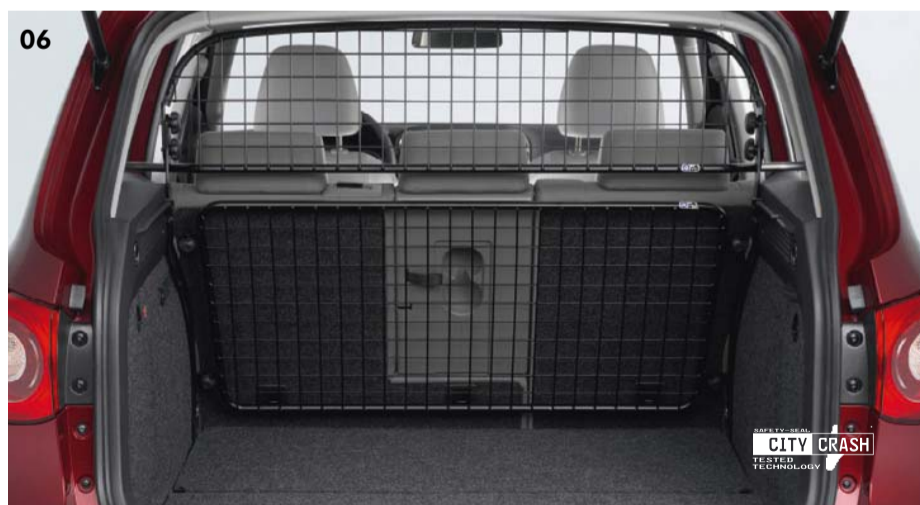
06 Grille de séparation entre dossier et pavillon : Réf : 5N0017221. Grille de séparation transversale derrière banquette : Réf : 5N0017222. Ces grilles, réalisées sur mesure, assurent une plus grande sécurité en cas de chargements encombrants. L'installation est sans perçage, ce qui permet de retirer les grilles sans laisser la moindre trace.
