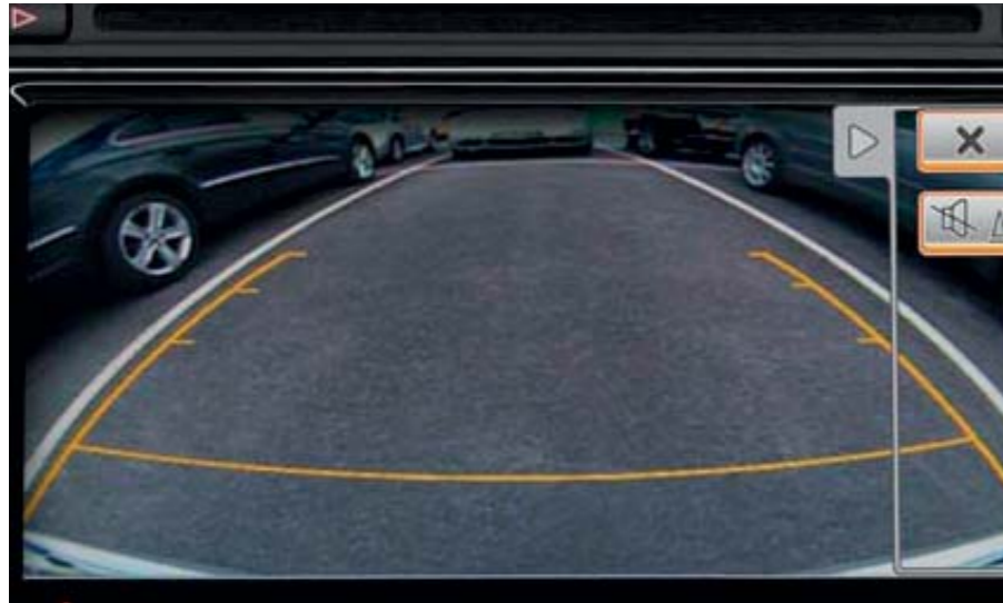
Caméra de recul avec visualisation de la zone située à l'arrière du véhicule sur l'écran de la radio ou de la radionavigation pour 'Carat' et 'Carat Edition'
