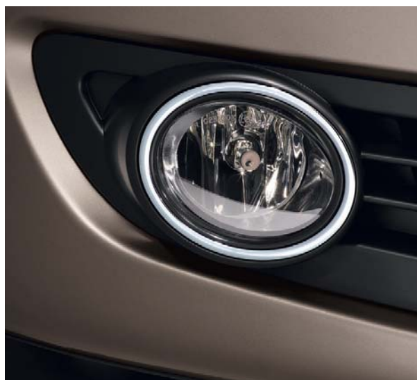
Les projecteurs antibrouillards et l'éclairage statique d'intersection.
