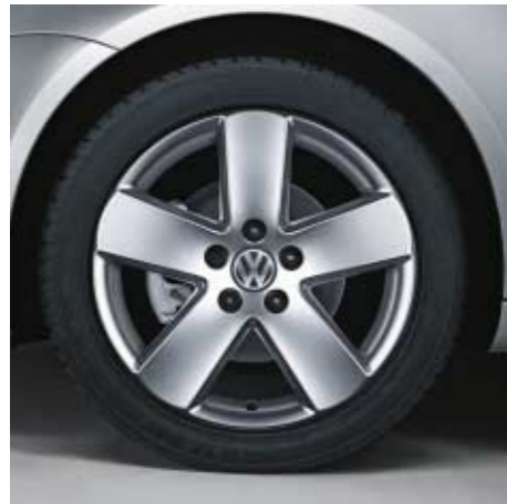
Jantes alliage "Monte Carlo" format 7 1/2 J x 17 avec pneumatiques 235/45 R17. En option sur Sportline.
