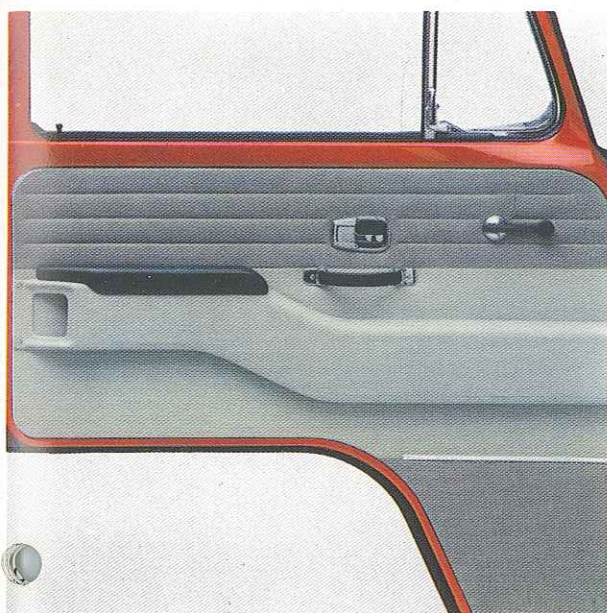
Canaux d'aération aux portières de la cabine servant d'accoudoirs.
