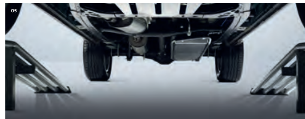
05 Protection de soubassement. Ces tôles d'acier robustes protégeront efficacement aussi bien la boîte de vitesses que le réservoir de carburant. | CL | CA | AV |
