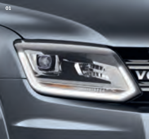
01 Projecteurs Bi-Xénon avec feux de jour à LED. Ils assurent les fonctions feux de croisement et projecteurs. Votre champ visuel s’élargit, vous gagnez en sécurité. L’élégante bande LED assure la fonction feux de jour. | TL | CL | CY | CA | AV |
