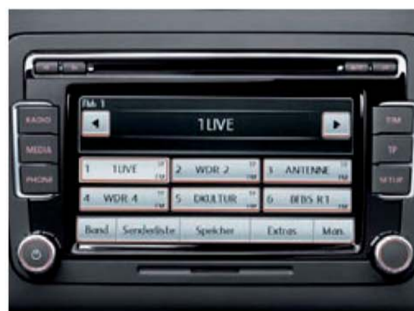
La radio 'RCD 510' avec son grand écran couleurs tactile, l'affichage de titres, le lecteur de cartes SD, le changeur 6 CD en façade, une puissance de 4 x 20 watts, haut-parleurs avant et arrière, lit les fichiers MP3 ou WMA.
