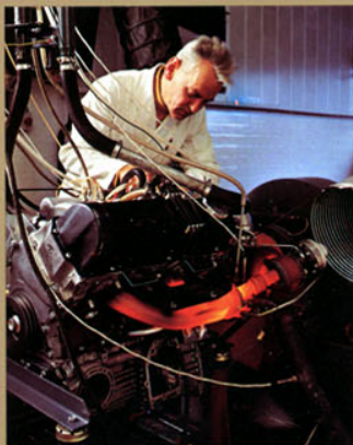
I Saab-Scantias topputrustade motorlaboratorium har turbomotorer körts ca 5000 timmar i bänk, vilket motsvarar en körsträcka på ca 600.000 km.
