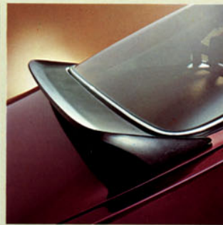
Spoiler bak höjer topphastigheten samt förbättrar stabiliteten och sänker bränsleförbrukningen vid höga farter.
