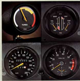
Fullständig instrumentering med bl.a. varvräknare och trykmätare för turbo-aggregatet.
