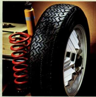
Bakfjädrar kombinerade med Bilstein gastryckstöldämpare. Pivotlagrade fjädrar fram.
