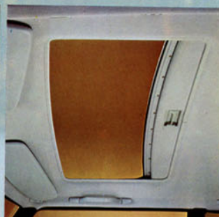
Saab Turbo levereras på vissa märknader med soltak av s.k. kassett-typ som standard. Hela innetaket av formpressad, stötupptagande glasfiber.
