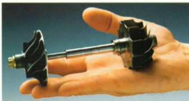
Het hart van de turbotechnologie. De uitlaatgassen drijven het turbine wiel aan de rechterkant aan, zodat de compressor aan de linkerkant meer lucht in de verbrandingsruimte kan persen. Hierdoor kan de motor met dezelfde cilinderinhoud meer vermogen en een hoger koppel leveren.
