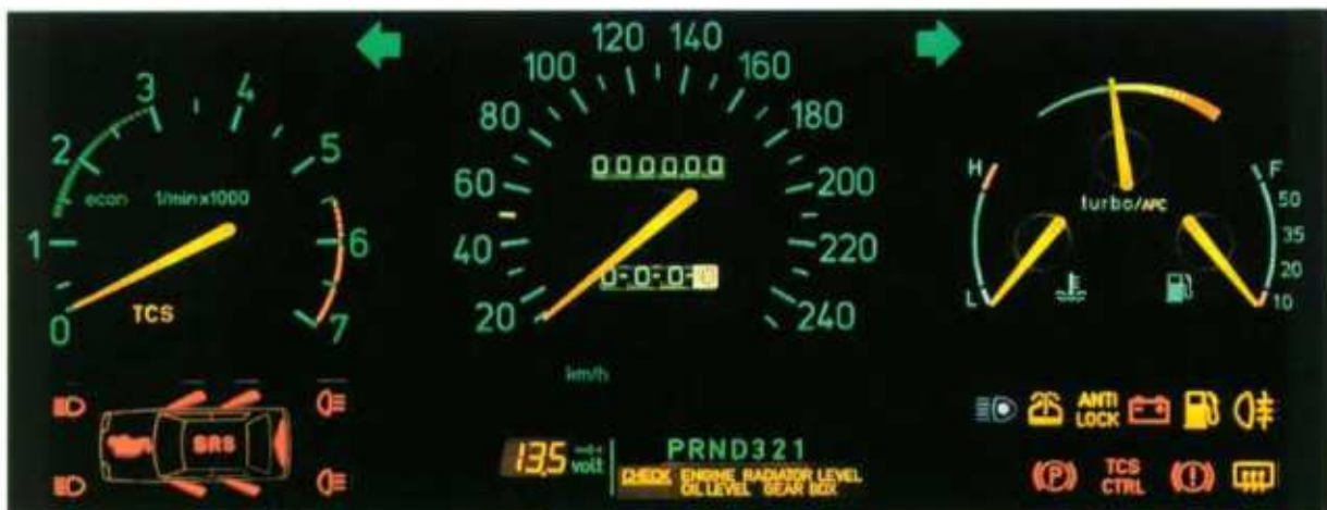
De instrumenten worden door indirect groen licht verlicht, een kleur die in het donker beter zichtbaar is dan rood. Het grafische pictogram en de waarschuwingsymbolen zijn normaal alleen zichtbaar wanneer de betreffende lampjes oplichten.
