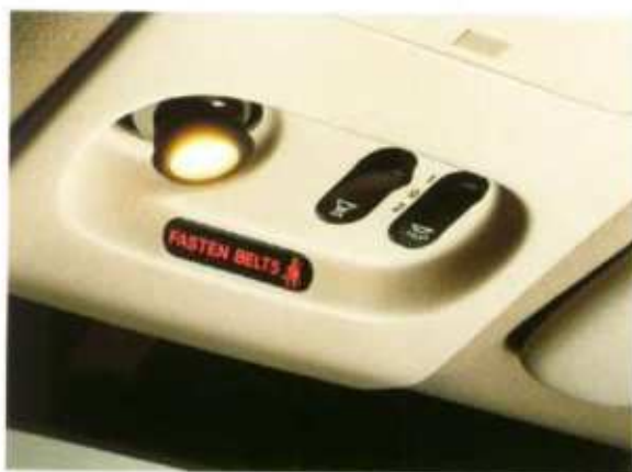
LEESLAMPJE/SPOTJE VOORIN. In de dakconsole bevindt zich ook de schakelaar voor de interieurverlichting.
