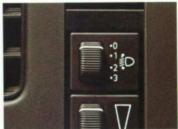
KOPLAMPAFSTELLING. Voor wanneer de auto zwaar beladen is. Zorgt dat u een goed zicht op de weg houdt en voorkomt verblinding van tegenoverkomend verkeer.
