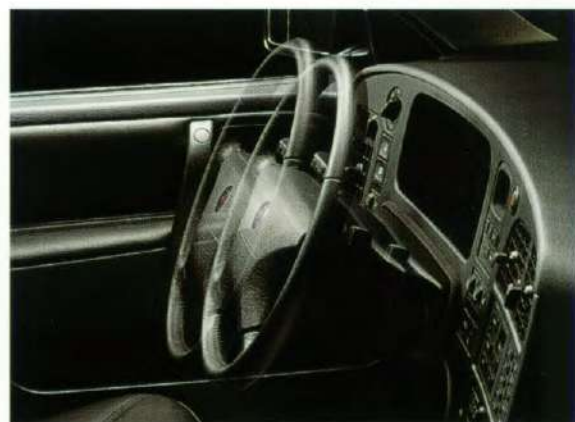
Het stuur is verstelbaar voor optimaal comfort, en voorzien van een full size airbag (65 ltr).
