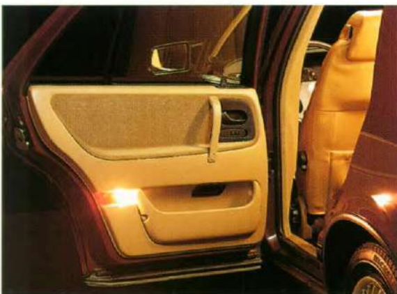
Instapverlichting in de portieren vergemakkelijkt het in- en uitstappen en waarschuwt het achteropkomend verkeer dat er een portier openstaat.
