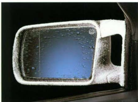
Elektrisch bediende en verwarmde buitenspiegels. Aan de bestuurskant is een groothoekspiegel aangebracht, die de traditionele „dode hoek” achter de bestuurder opheft.
