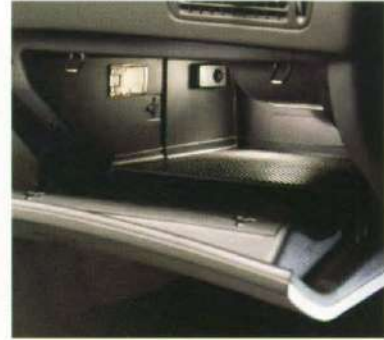
Cooler Extra: Bei Fahrzeugen mit Klimaanlage kann das Handschuhfach gekühlt werden.
