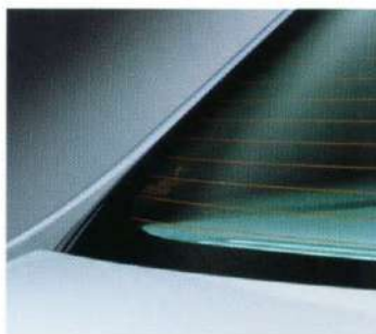
In die Heckscheibe eingelassene Antenne: Schutz vor Beschädigung, keine Windgeräusche, kein Einfrieren.
