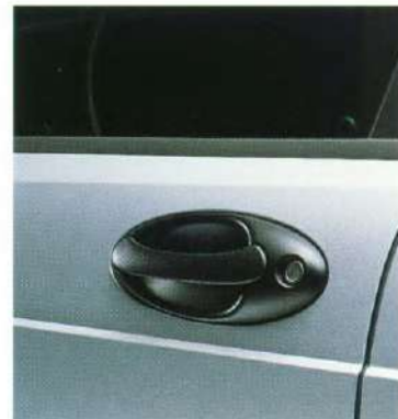
Abgekapselter Schließmechanismus, rotierender Zylinder: hier kommt nur hinein, wer den richtigen Schlüssel mitbringt.
