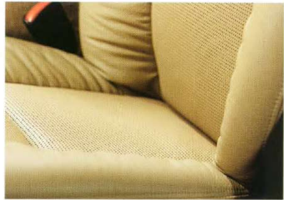
Weltpremiere im Pkw: ventilierte Vordersitze. Das individuell einstellbare Gebläse im Rücken- und Sitzkissen sorgt für wohltemperierten Sitzkomfort.
