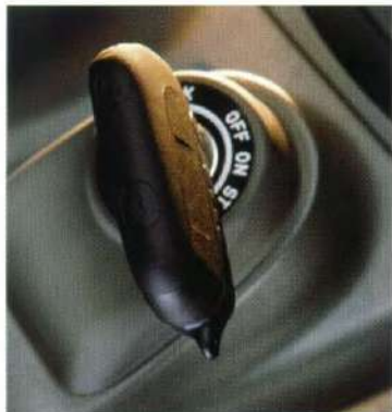
Beim Abziehen des Zündschlüssels sorgt eine Schaltsperre dafür, daß kein anderer Gang als der Rückwärtsgang eingelegt werden kann.
