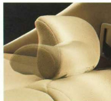
Für eine bessere Sicht nach hinten lassen sich die Kopfstützen im Fond verstellen.
