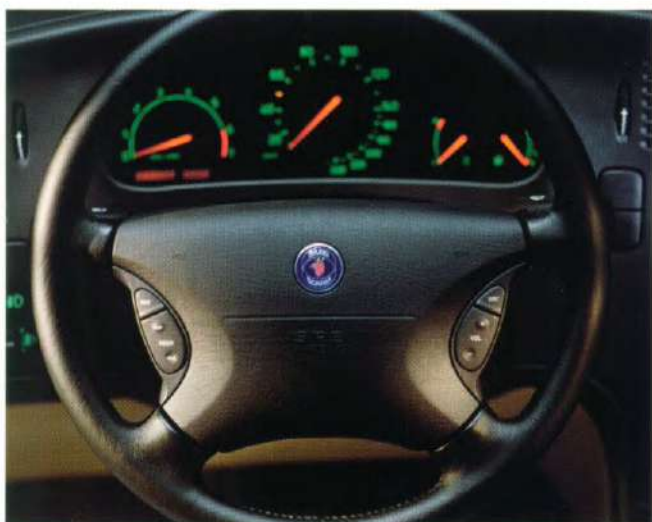
Die wichtigsten Funktionen des Audio Systems können bequem vom Lenkrad aus gesteuert werden.
