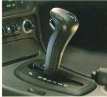
4-Gang-Automatikgetriebe mit 3 Fahrprogrammen: Normal, Winter und Sport.
