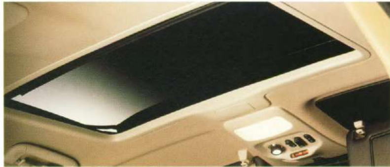
Elektrisches Glas-Hubschiebedach. Gleitet nach hinten weg oder kann an der Hinterkante angehoben werden. Das Glas ist – wie bei den Fahrzeugfenstern – grün coloriert und wärmeabsorbierend. Es reduziert die Wärmeeinstrahlung der Sonne um rund 50%.
