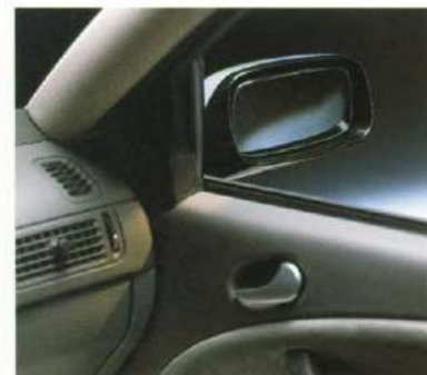
Elektrisch anklappbarer Außenspiegel auf der Beifahrerseite mit automatischer Rückstellung. Nimmt beim Einparken die Bordsteinkante ins Visier.
