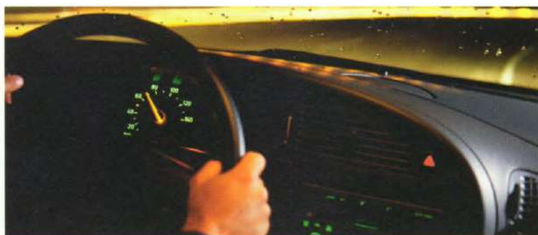
Die Night Panel-Funktion blendet außer dem Tachometer alle Anzeigen aus und ermöglicht bei Nachtfahrten die Konzentration auf das Wesentliche. Muß der Fahrer aktuell über andere Fahrzeugdaten informiert werden, erfolgt eine automatische Einblendung der entsprechenden Instrumente.
