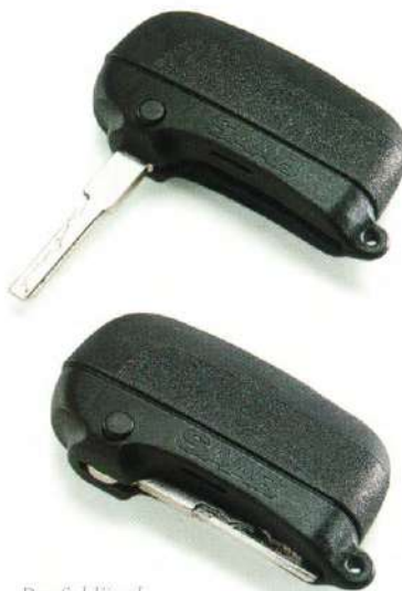
Der Schlüssel läßt sich wie ein Taschenmesser einklappen. Die Fernentriegelung von Türen und Kofferraum funktioniert auf Knopfdruck.
