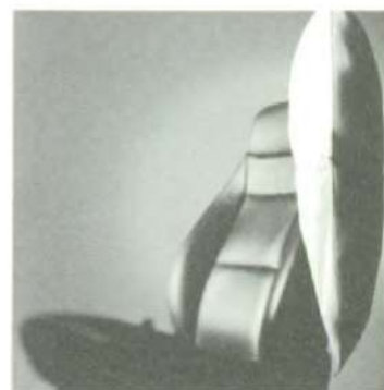
DER ZWEIFELIGE FULLHEIGHT-SEITENAIRBAG SCHÜTZT KOPF- UND BRUSTBEREICH.
