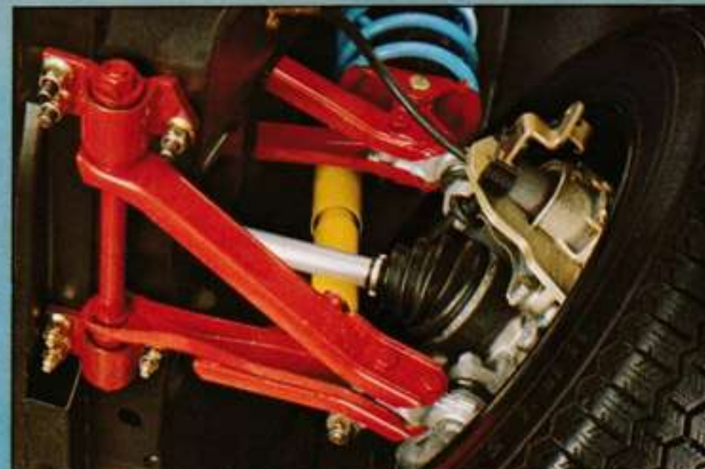
Die Vorderräder sind an doppelten, V-förmigen Querlenkern aufgehängt. Die Federn sind in Drehbolzen gelagert und arbeiten daher stets gradlinig und mit maximalem Wirkungsgrad, ohne Verformungstendenzen. Im Zusammenspiel mit dem großen Federweg garantiert diese Konstruktion eine sichere Straßenlage und ein hohes Querbeschleunigungsvermögen, auch auf schlechten Straßen.
