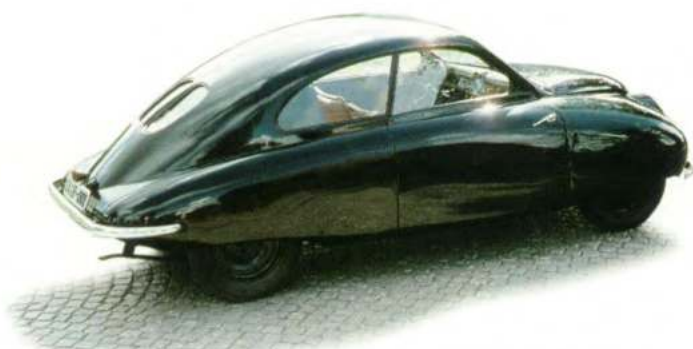
Met de introductie van de eerste Saab, de Saab 92, bracht de onderneming de vliegtuigtechnologie op aarde. De kenmerken van deze auto, die werd ontworpen door vliegtuigtechnologen, waren een aërodynamisch ontwerp, een dwarsgeplaatste motor en voorwielaandrijving.
