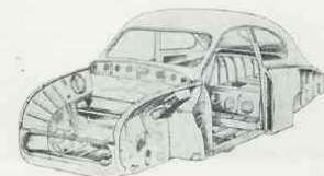
SAAB-92 har helsevejst, selv bærende Staalkarosseri og har saaledes ingen Chassissramme. Denne Konstruktion er naturligvis stærkt vægtbesparende og Staalkarosseriet yder desuden den størst mulige Sikkerhed for Passagererne.
