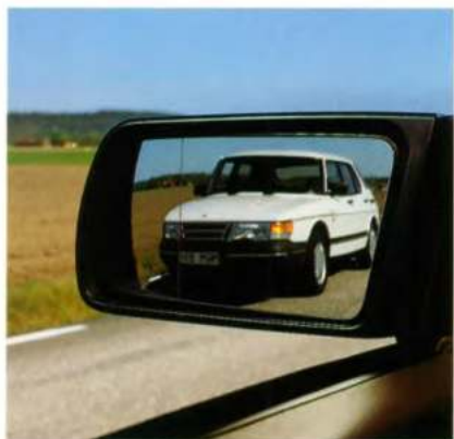
De linker buitenspiegel is van het groothoek type, waardoor de dode hoek wordt opgeheven.
