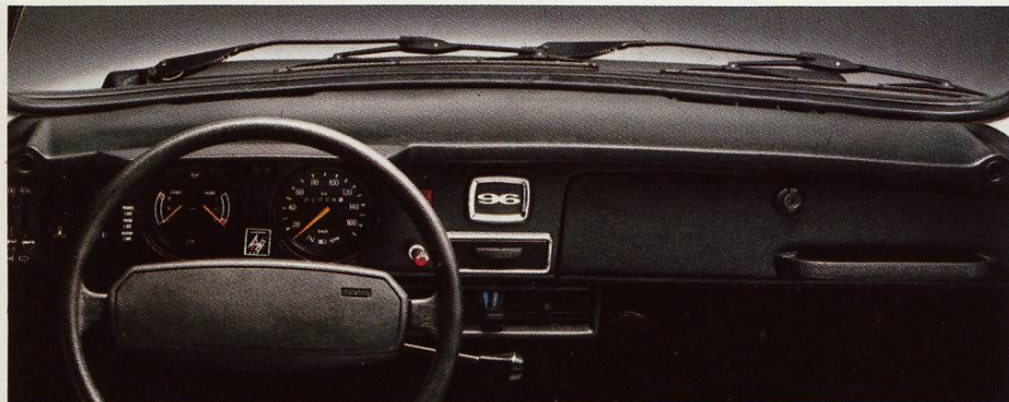
Das Armaturenbrett des Saab 96 GL. Gut ablesbare Instrumente. Alle Bedienelemente in Griffnähe. Das Lenkrad ist mit einem energieabsorbierenden Prallkörper versehen.
