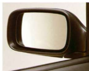
Elektrisch bediende en verwarmde buitenspiegels. Met een groothoekgedeelte aan de bestuurderskant om de dode hoek op te heffen.
