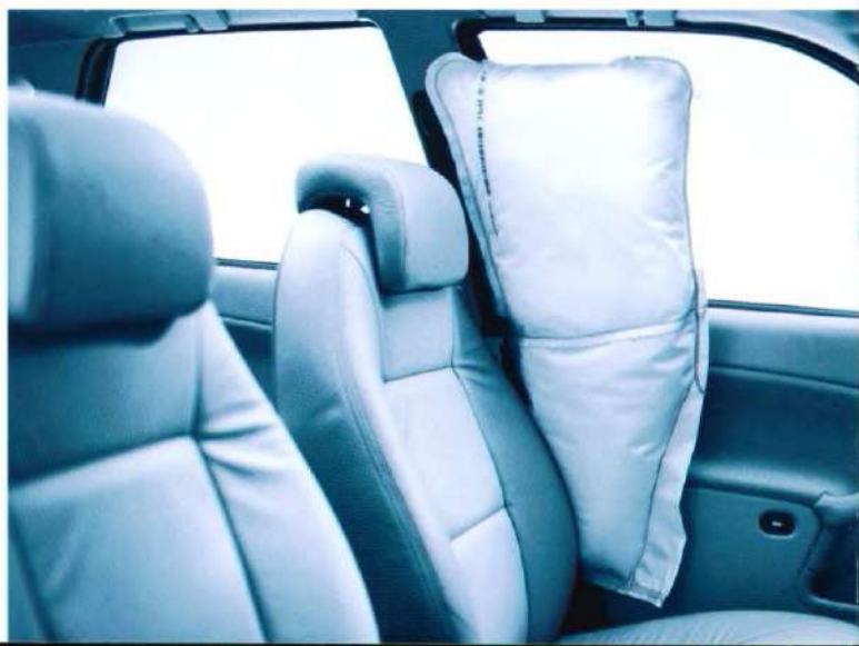
De twee voorstoelen zijn aan de zijkant voorzien van zij-airbags voor extra bescherming bij een aanrijding van opzij.
