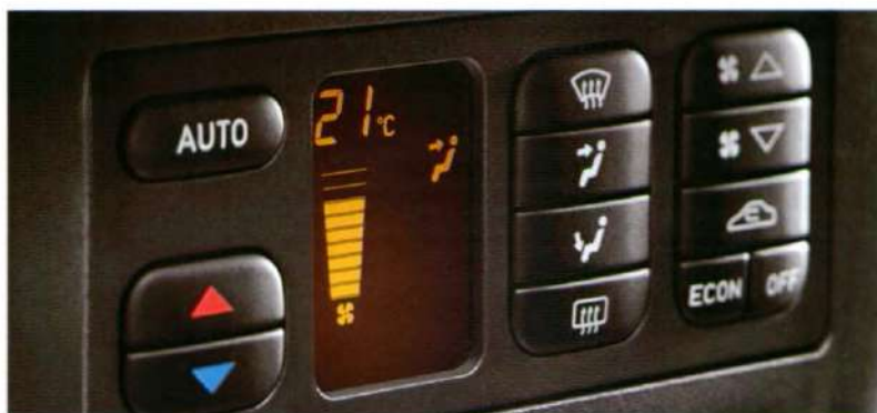
Automatische klimaatregeling (ACC) handhaaft automatisch de ingestelde temperatuur, ongeacht de weersomstandigheden buiten.
