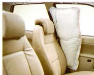
In de voorstoelen zijn zij-airbags aangebracht voor extra bescherming bij een aanrijding van opzij.
