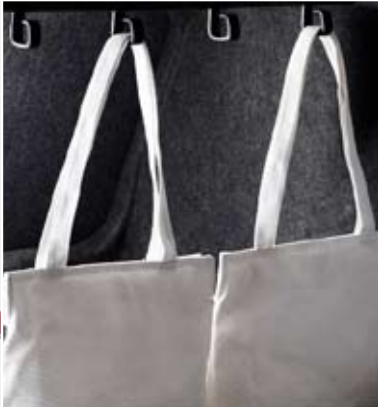
Bärkasseshållare – monteras under hatthyllan. Fyra krokar som håller bärkassarna på plats i bagageutrymmet.
