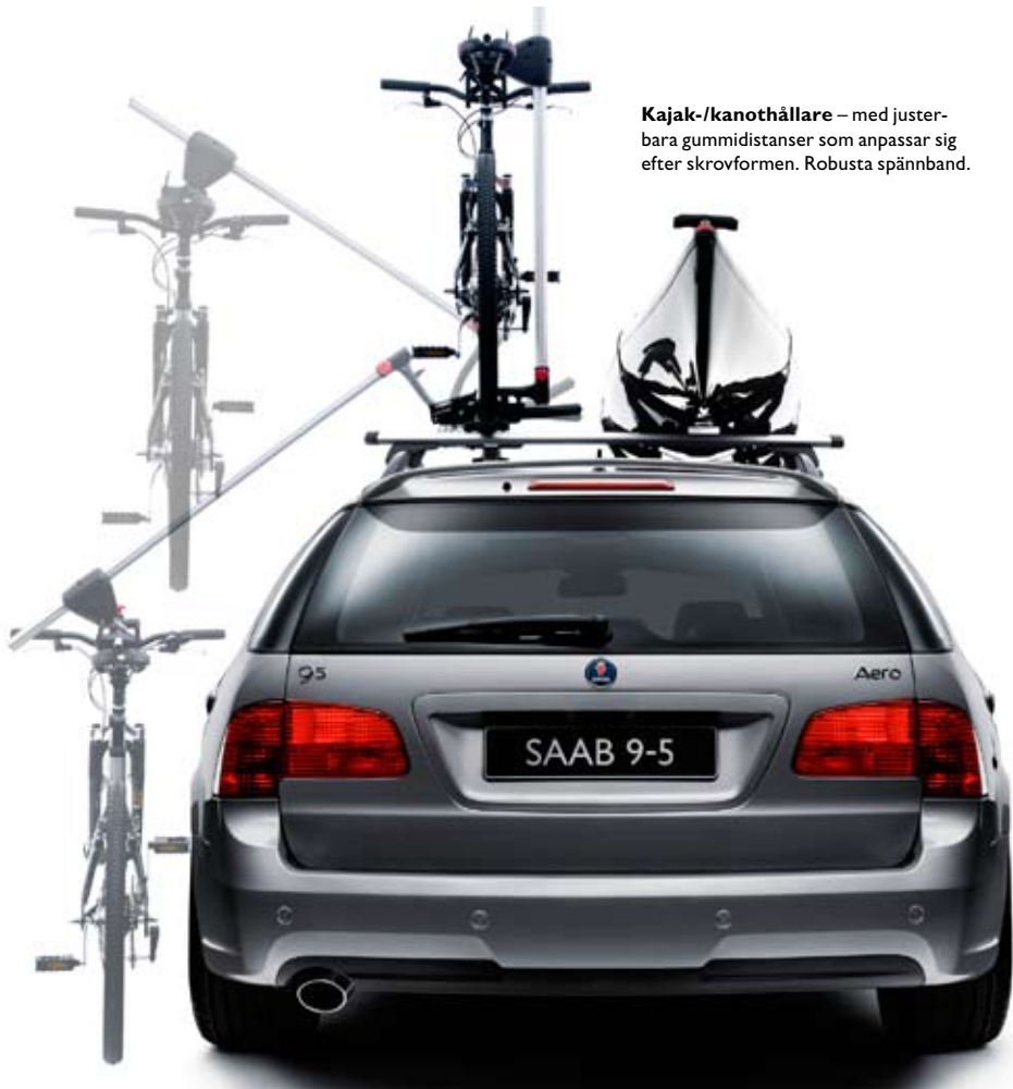
Cykelhållare med lift – cykeln monteras i höjd med dörren och lyfts upp på taket med hjälp av gasfjädrar. Säkras enkelt stående på lasthållarna. Låsbar.
