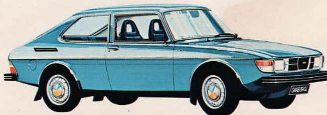
Saab 99 GL Combi Coupé, 3-türig. 2-Vergasermotor, 79 kW (108 PS) DIN, Handschalt- oder automatisches Getriebe.
