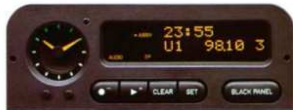
SID 3 is een volledige tripcomputer. Naast de hierboven reeds genoemde functies zijn er nog vijf andere functies, zoals resterende afstand tot de plaats van bestemming, geschatte aankomsttijd en gemiddelde snelheid.
