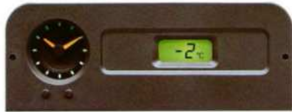
SID 1 geeft de tijd en de buitentemperatuur aan. De twee toetsen onder de klok dienen om de tijd in te stellen en de temperatuur-aanduiding te kiezen (Celsius of Fahrenheit).
