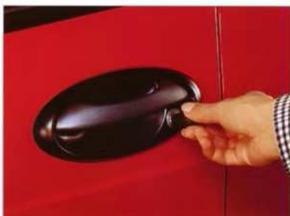
De „deadlock” functie maakt de auto moeilijk toegankelijk voor dieven. Het portier kan niet van binnenuit geopend worden, maar gaat alleen met de contactleutel open.
