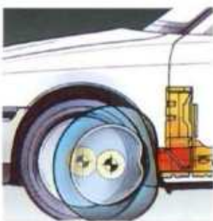
Het speciale „offset versterkingssysteem” aan de voertafel van de deuren, waar Saab patent op heeft, voorkomt dat de voorwielen bij een botsing in het interieur kunnen binnendringen.
