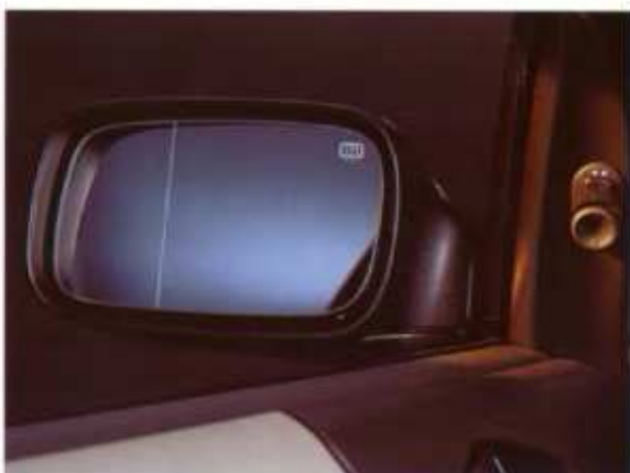
Elektrisch verstelbare en verwarmde buitenspiegels. Aan de bestuurderskant is een groothoekspiegel aangebracht, die de traditionele „dode hoek” achter de bestuurder opheft.
