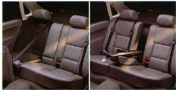
De achterbank, die volledig of in 40% neergeklapt kan worden, is voorzien van een handig skilruk in de armleuning.
