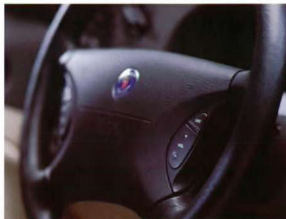
Die wichtigsten Funktionen des Audio-Systems können über Fernbedientasten im Lenkrad gesteuert werden.
