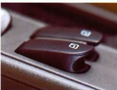
Elektrische Fensterheber. Funktionstaste zum Öffnen drücken, zum Schließen anheben.
