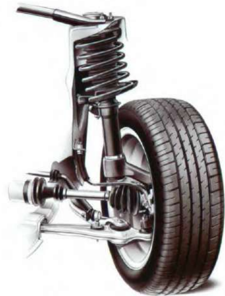
Versetzte Federbeine mit verlängertem Federweg, verbunden mit neu abgestimmter Lenkung für verbessertes Handling und mehr Fahrkomfort.
