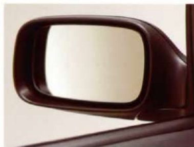
Die Außenspiegel lassen sich elektrisch verstellen und sind beheizbar. Der Spiegel auf der Fahrerseite verfügt über einen Weitwinkelbereich, der „tote“ Winkel eliminiert.
