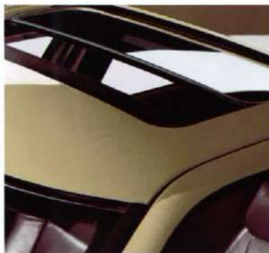
Elektrisches Glas-Hubschiebedach mit Innenblende.
