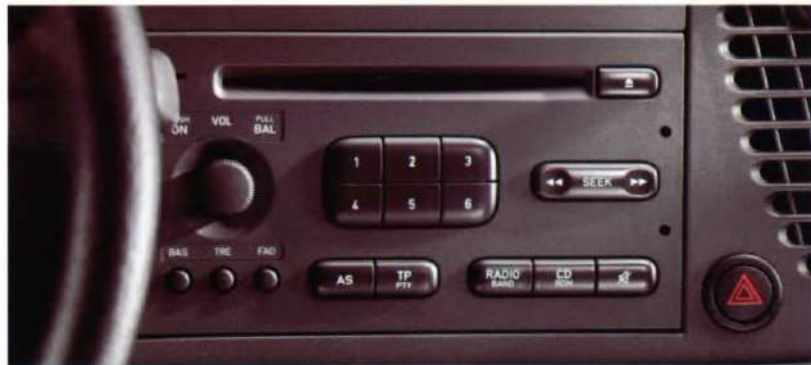
Die Audio Systeme umfassen RDS-Radio, CD-Player, elektrische Antenne und wahlweise vier oder sechs Lautsprecher.
