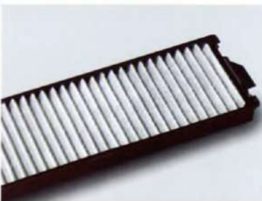
Der elektrostatische Innenraum-Luftfilter verhindert, daß Staub, Pollen und andere Partikel über 0,004 mm Größe in die Fahrgastzelle gelangen.
