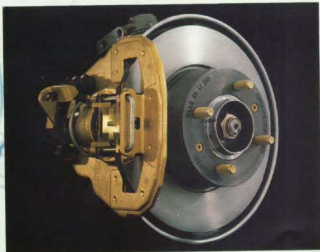
Goed ontwikkeld remsysteem met schijfremmen rondom. Dubbel circuit voor optimale veiligheid. Asbest-vrije voeringen met een lange levensduur.
