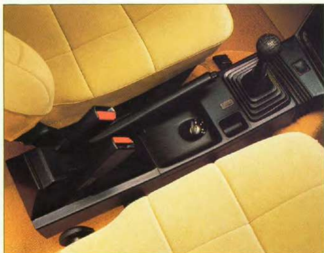
De bedieningsorganen zijn in logisch gerangschikte groepen geassembleerd. Op de afbeelding is de middenconsole van een Turbo met alle bedieningsorganen voor het starten te zien: Contactslot en schakelaar voor binnenverlichting, contact/vergrendeling versnellingspook, versnellingspook, handrem en gordelsluiting.
