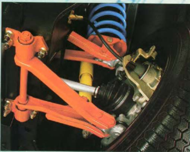
Door de dubbele triangelvormige draagarmen wordt de stabiliteit groot. De auto ligt uiterst vast op de weg, voornamelijk dankzij de bewegend gemonteerde veren die dus altijd recht zijn en doelmatig blijven werken.
