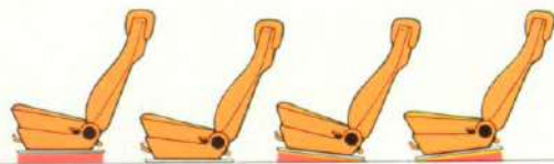
Het zitkussen van de bestuurdersstoel kan door middel van een knop op hoogte en helling worden afgesteld.
