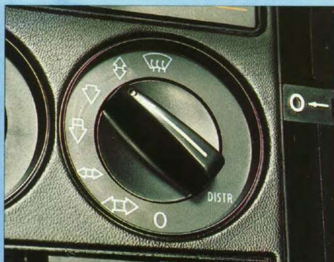
De luchtverdelingsknop met geprogrammeerde standen. Zeven logisch afgestelde standen. Kan snel van te voren worden afgesteld zonder de noodzaak opnieuw te moeten instellen. Vacuüm-gestuurde kleppen zorgen ervoor dat het systeem moeiteloos werkt.
