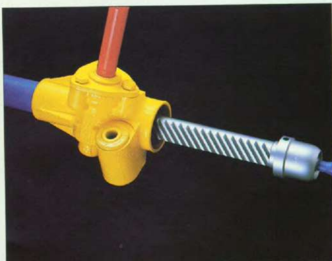
De rondsel- en tandheugelbesturing reageert onmiddellijk en duidelijk op de geringste beweging van het stuurwiel. Ideaal in combinatie met voorwielaandrijving.
