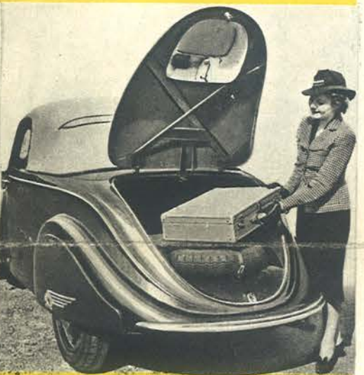
Le couvercle du coffre AR du coupé est maintenu levé par un dispositif de sécurité. Bagages et roue de secours sont à l'abri de la poussière.
