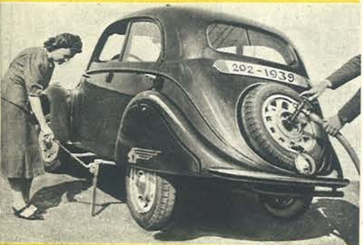
Le cric latéral, aisément fixé dans son logement, soulève la voiture sans effort. L'orifice central de remplissage facilite le ravitaillement en essence.
