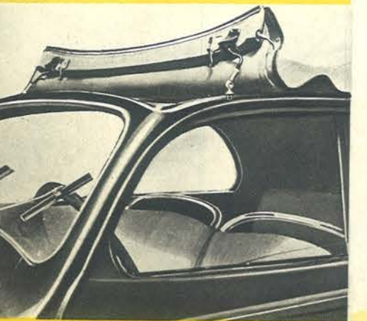
Un dispositif spécial permet de tendre la capote de la Berline afin de l'appliquer hermétiquement sur les rebords du pourtour métallique.
