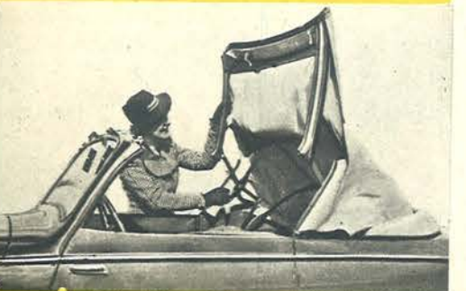
La capote du coupé est de manœuvre facile et rapide; elle s'applique hermétiquement sur les glaces levées et sur le pare-brise.
