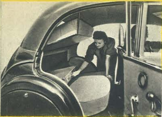
Le dossier AR pivotant de la Berline, est maintenu levé au moyen d'une bride, et permet l'accès commode aux bagages.
