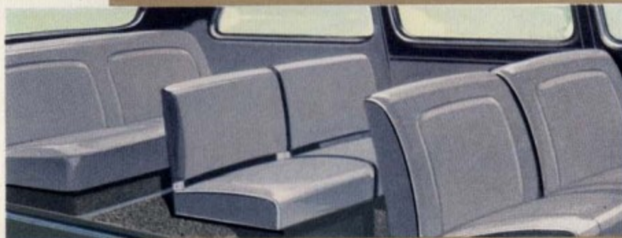
Les strapontins peuvent se replier et se rabattre contre les sièges AV.
