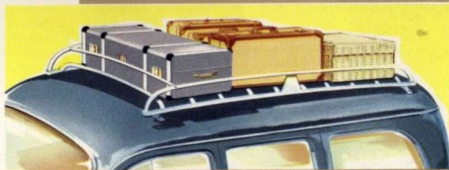
Pour le transport des gros bagages, il suffit de monter (en quelques instants) un porte-bagages sur les 4 romaines du toit.
