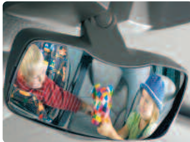
Le miroir enfants permet de surveiller depuis l'avant l'ensemble des places arrières, sans avoir à modifier la position du rétroviseur intérieur.
