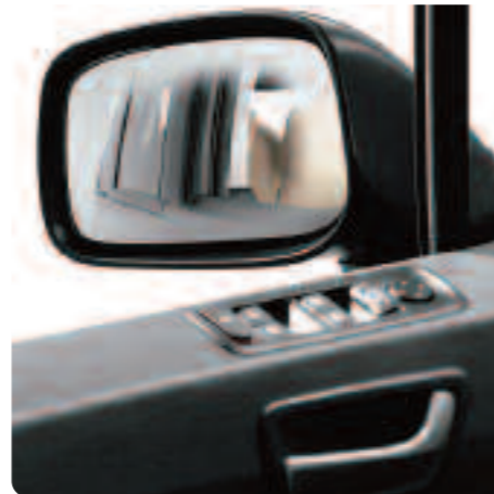
Les rétroviseurs extérieurs électriques sont dégivrants, réglables et rabattables électriquement. Le conducteur peut condamner les portes et les vitres arrières depuis la platine intégrée à sa portière.
