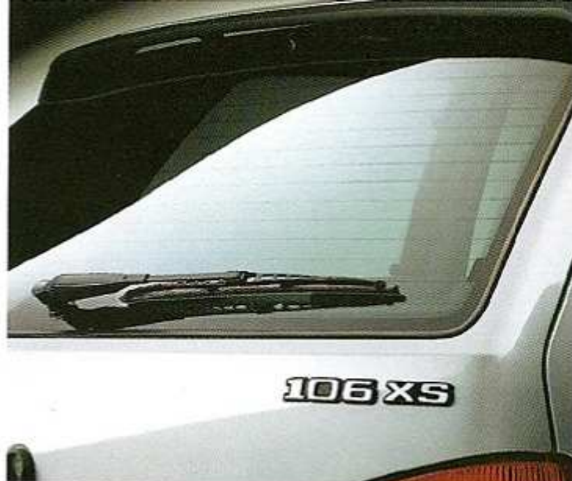
Lunette arrière avec dégivrage/désembuage et lave-vitre/essuie-vitre
