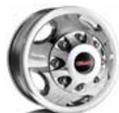
17 PO, EN ACIER PEINT CHROMÉ (PO6): DE SÉRIE AVEC LES 3500HD SLE ET SLT À ROUES ARRIÈRE JUMELÉES
