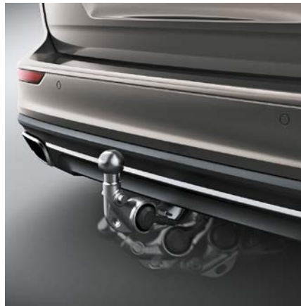
Crochet d'attelage amovible semi-électrique 13 broches. Charge max. 100 kg. Poids remorquable max. 2000 kg. 1200 €
