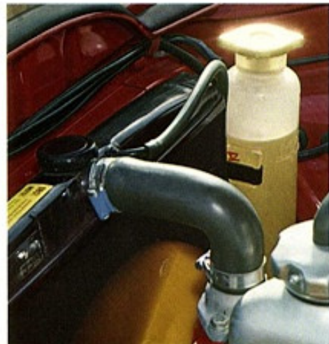
Un système de refroidissement en circuit fermé permettant des températures allant jusqu'à -40°
