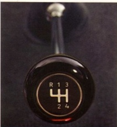
Un levier de changement de vitesse aux positions distinctes
