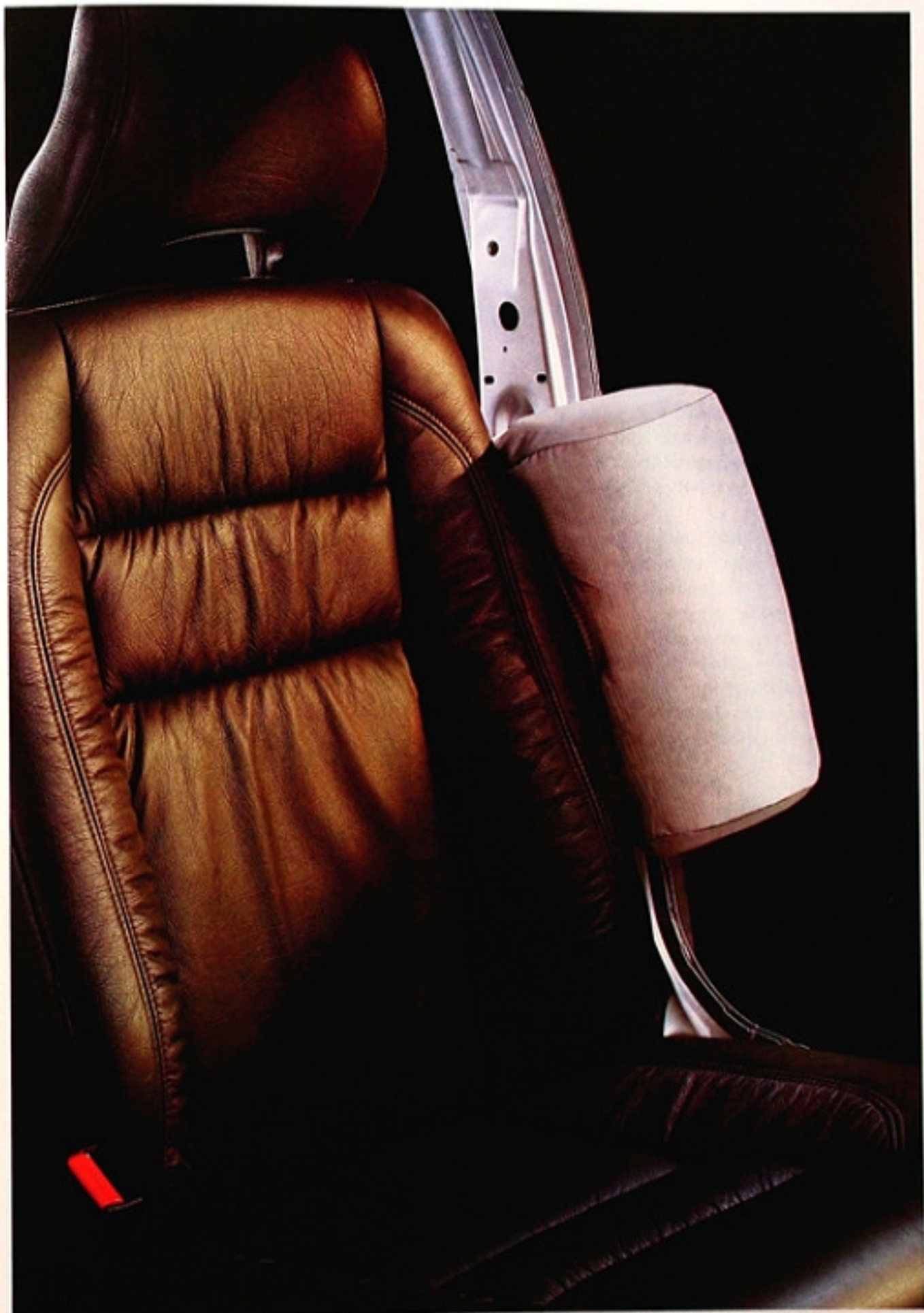
L'airbag de protection latérale de Volvo (option) est fixé dans la partie latérale extérieure du siège avant, plutôt que dans la porte, pour garantir sa bonne position par rapport au passager, même si le siège est incliné.
